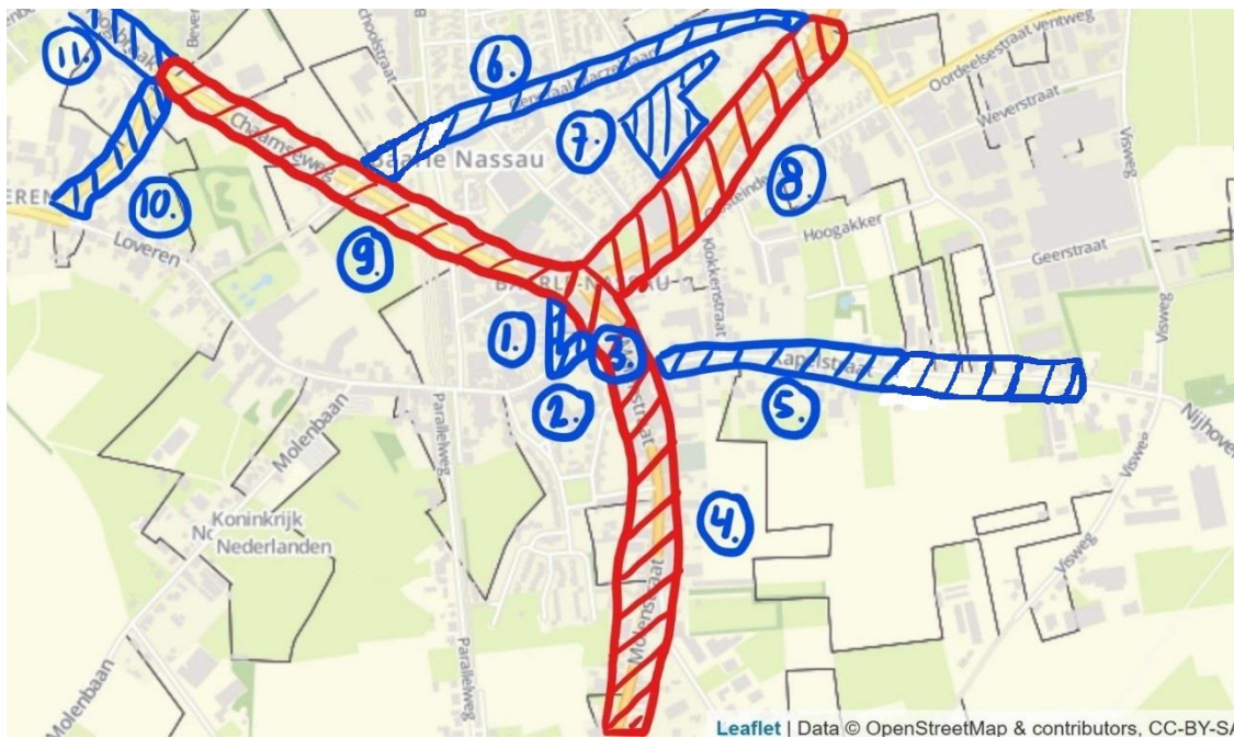
Figuur 5.2: Centrum plan en bijbehorende rioolwerkzaamheden over de aankomende 10 jaar.
